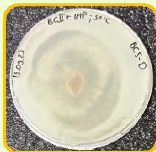
Abb. 3: Agarplattenkultur eines Pilzisolates vom UFZ-Forschungsgründach. Der Pilz wächst auf einer aliphatischen Polyester-Polyurethan-Dispersion als einziger Kohlenstoff- und Energiequelle. Die Pfeile bezeichnen Bereiche, in denen das Polyurethan depolymerisiert und die Trübung des Nährmediums dadurch beseitigt wurde (Foto: Stefanie Clauß, UFZ).
